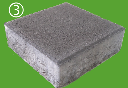
Después del desgaste de la eflorescencia
