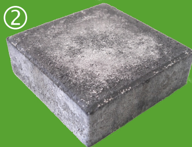
Eflorescencia después de 3 a 9 meses
