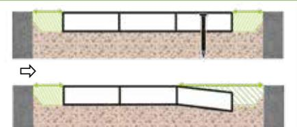
Um ein Aufkanten durch Bremskräfte zu vermeiden, kann das ECORASTER® bei Parkplätzen mit Erdnägeln fixiert werden. Alternativ kann das System auch abgesenkt werden.\*
