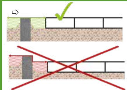
Die ECORASTER® Bodengitter bitte flächig auf einer Ebene mit der Einfassung verlegen.\*
